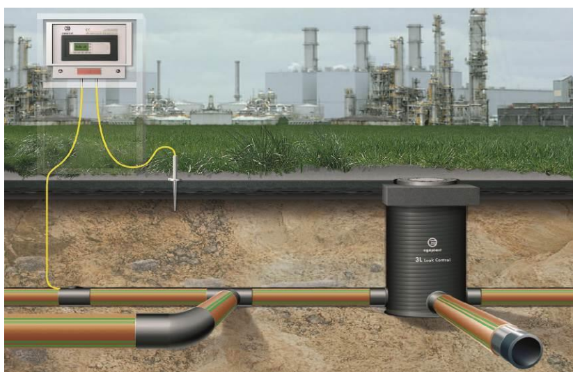
Bild 4: Permanent auf Beschädigungen überwachtes Mehrschichtrohrsystem
