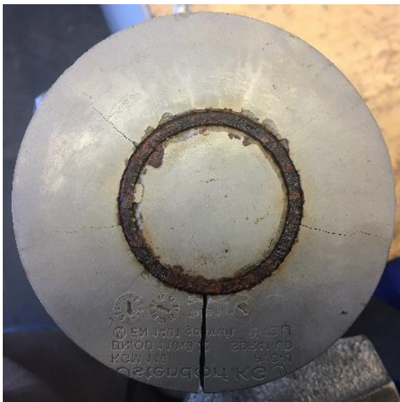
Abbildung 2.19: Rohrprobe mit Zement vergossen als Vollverschluss
