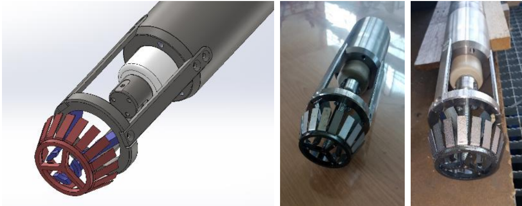
Abbildung 2.59: Lösungsvariante für eine Abbauelektrode für vollflächigen Verschluss, Aktive Elektrode rot, Passive Elektrode blau
