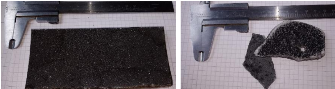
Abbildung 2.4: Probekörper für Vorversuche (Scaleschicht auf Casingsegment < 1mm links, Scherben bis 10 mm rechts)
