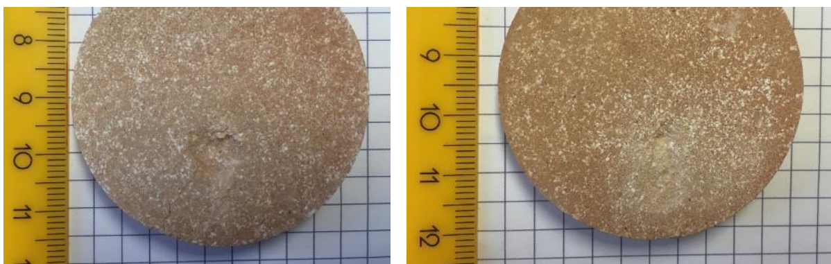
Abbildung 2.25: EIV-Durchschlag mit Rissbildung an einem Ba/SrSO 4 -Presslings, links Vorderseite, rechts Rückseite
