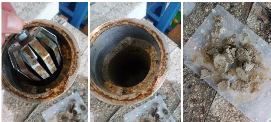
Abbildung 2.38: Löseergebnis in betonierten Scales
