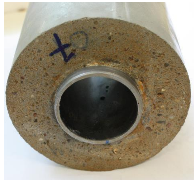
Abbildung 2.20: Rohrprobe mit äußerer Zementummantelung
