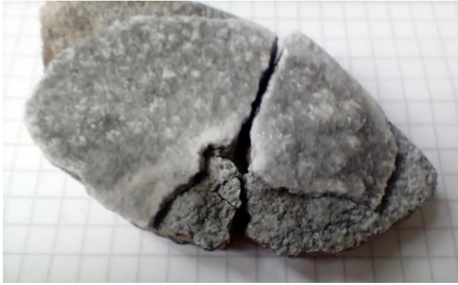
Abbildung 2.11: Schaliges Abplatzen von Scaleschichten
