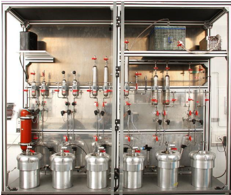
Abbildung 2.60: instationäre Anlage zur Permeabilitätsbestimmung der Zementation
