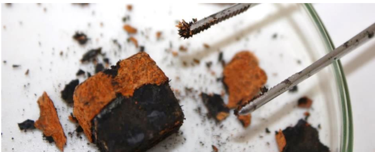
Abbildung 2.21: Probe nach dem Entfernen des Drahtes der Versuchsreihe mit tägl. frischer Lösung und gerührt
