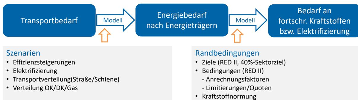
Abbildung 7 Schema der Modellierung des Kraftstoffbedarfs
