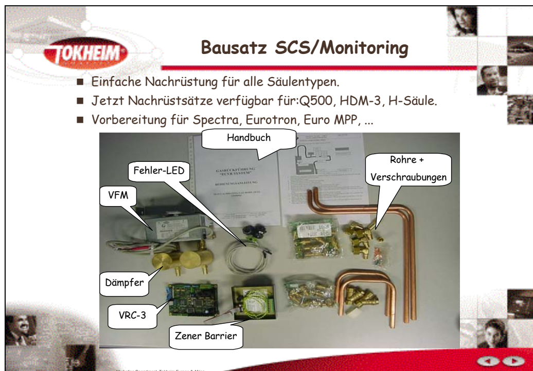
Bild 5: Nachrüstbausatz mit den Komponenten VFM II, VRC3, Zener Barrier, LEDs, zapfsäulenbezogenen Rohren, Verschraubungen etc. und der entsprechenden Dokumentation.
