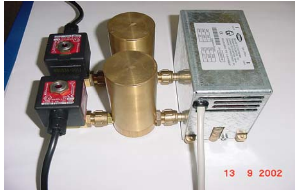
Bild 4: Komponenten im Hydraulikbereich der Zapfsäule, beide Zapfsäulenseiten, in der Mitte die Dämpfervolumen für beide Seiten der Zapfpistole.
