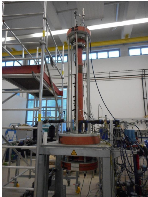
Abbildung 47: Bohrlochsimulator Typ I, ohne Isolierung. Orange Heizmatten sind sichtbar. Gesamtaufbau ca. 3 m hoch.
