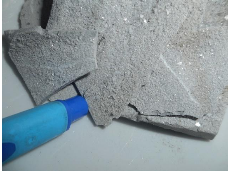
Abbildung 112: Neu gebildete Portlandit-Kristalle auf der Oberfläche des Zements aus Casing 1
