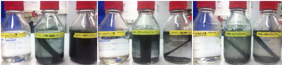
Abbildung 24: Langzeitversuche unter atmosphärischem Druck mit einer CH 4 - und CO 2 -haltigen Gasphase. Die dargestellten Ansätze wurden bei 40 °C, 60 °C und 80 °C inkubiert.
