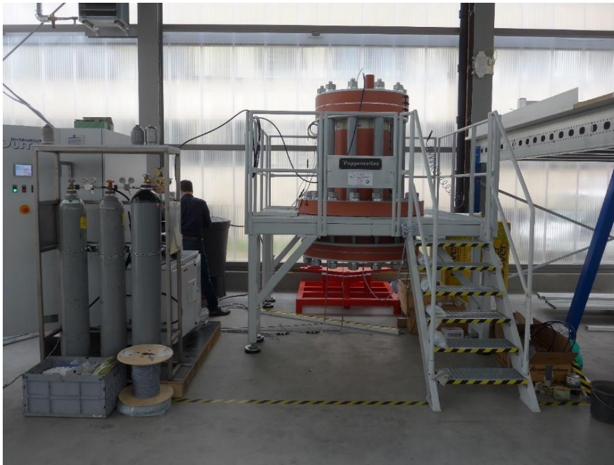
Abbildung 56: Bohrlochsimulator Typ II. Rechts im Bild: Versuchsstand mit Autoklavensystem ohne Isolierung. Im Bereich zwischen den Zugstangen befindet sich die Probe, die durch einen Stahlmantel und eine orange Heizmatte verdeckt ist. Darüber und darunter liegen die beiden Autoklavenkammern. Links im Bild: Gasflaschen und Steuereinheit.
