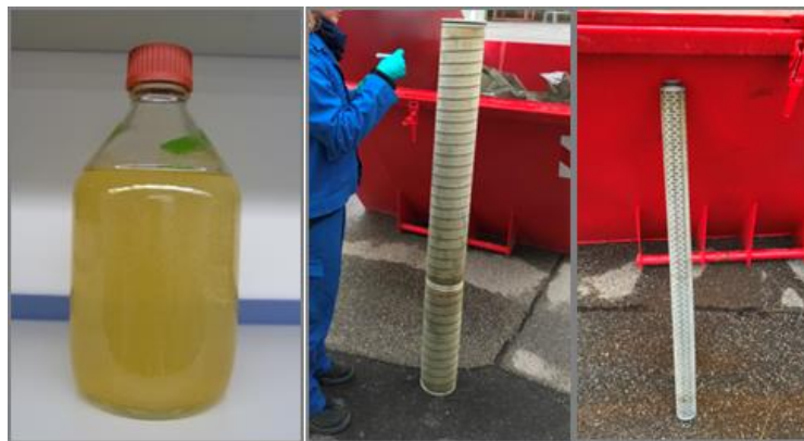
Abbildung 11: Gewinnung des Probenmaterials zur Anreicherung einer aktiven Biozönose aus dem Lagerstättenwasser sowie aus den Filterkerzen mit 2\ \mu\text{m} - bzw. 3\ \mu\text{m} -Porenweite.
